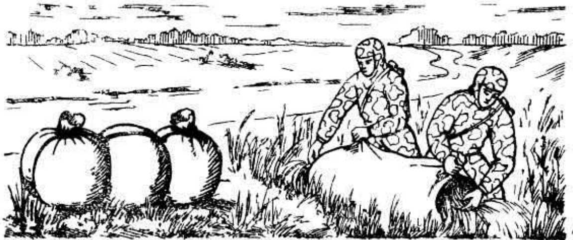
Рис. 42. Устройство поплавка из плащ палатки
